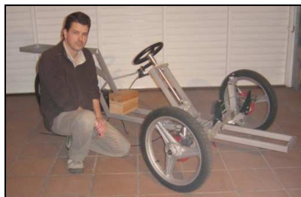
Prototipo VII (año 2007) : velocidad max : 60 km/h, autonomía : 115 km, potencia motor : 1,5 kw, tensión 24 V, peso : 71 kg (con baterías de litio-ion incluidas) Patrick Renau (socio nº1)
