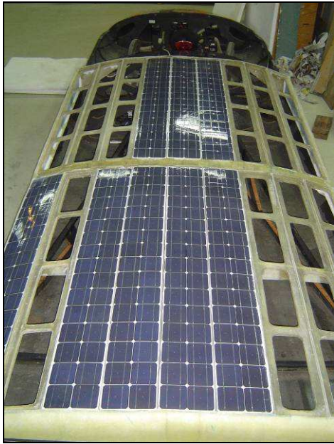
Carcassa superior del nou sistema de captació fotovoltaica
